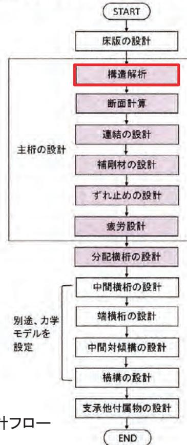
鋼鈹桁橋の設計フロー
