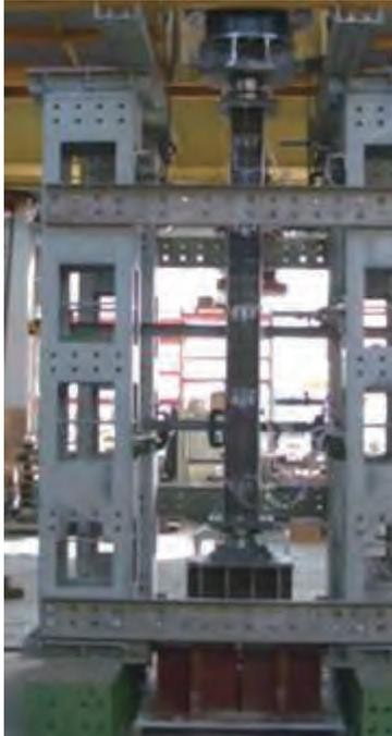
H形断面部材の載荷試験
