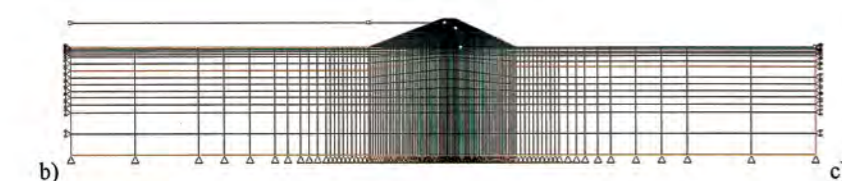
図-4 ため池堤体の常時と地震時安定解析の例: a) 解析モデル (D c は標準プロクターによる); b) 非線形 FEM 自重解析のメッシュ; c) Duncan-Chang モデル
