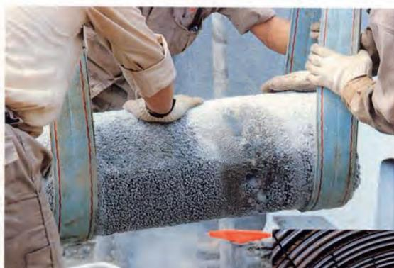
採取した凍結砂礫試料
