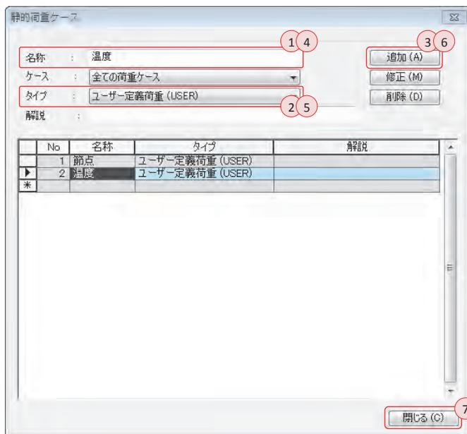
02.6.2 節点荷重の入力 節点 5 に重力方向の集中荷重 20kN を入力する。
