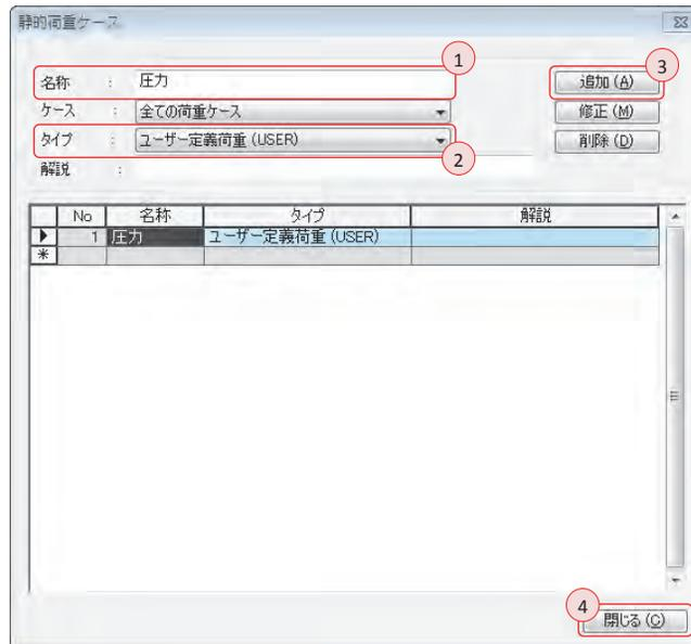
02.6.2 圧力荷重の入力 平板要素に  $10 \text{ kN/m}^2$  の圧力荷重を入力する。
