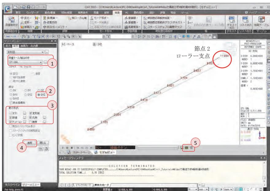
節点 2 のローラー支点で上向きの 11.034mm の変位が発生することが確認できる。
