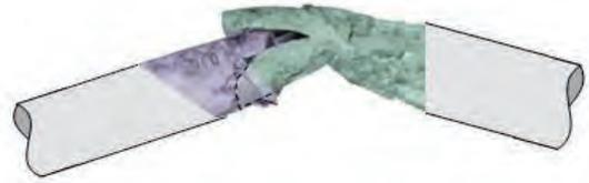
溶接部において破断し、喰い込んでいたガス導管
