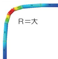
鉄筋曲げ応力度
