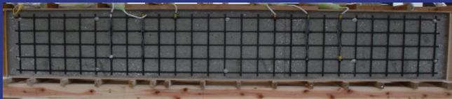
3. CFRP格子筋の配置
