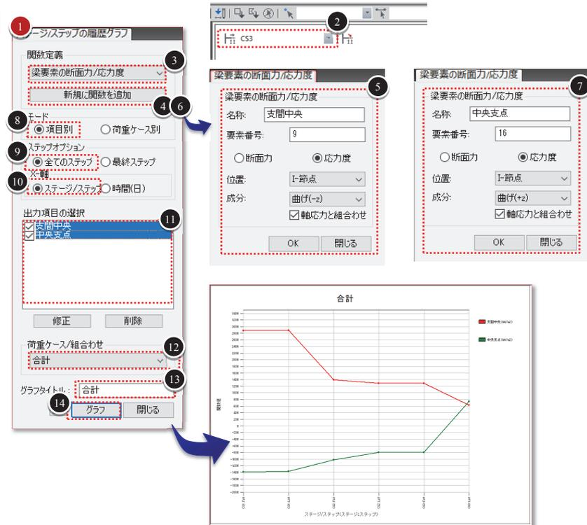
\*1 “曲げ(-)”は断面z軸の下端における曲げ応力で、“曲げ(+)”は断面z軸の上端における曲げ応力を意味します。
