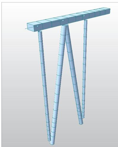
『 水平力载荷による増分解析』
