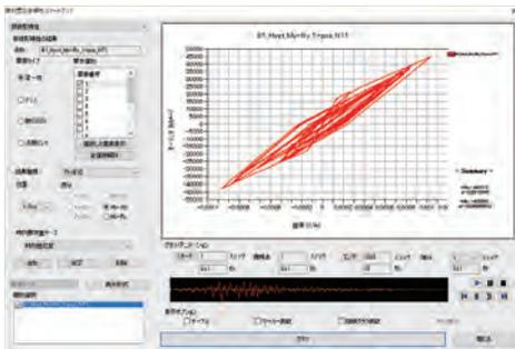
部材の断面力履歴確認
