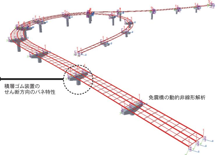
積層ゴム装置のせん断方向のバネ特性
