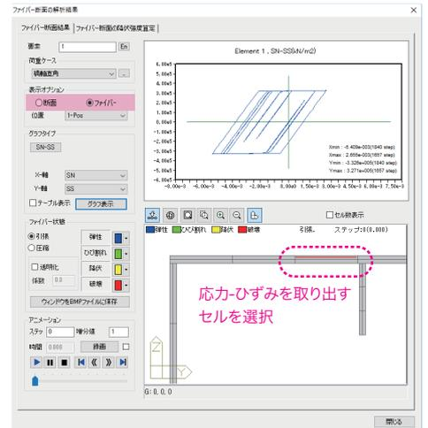
セルの応力履歴結果
