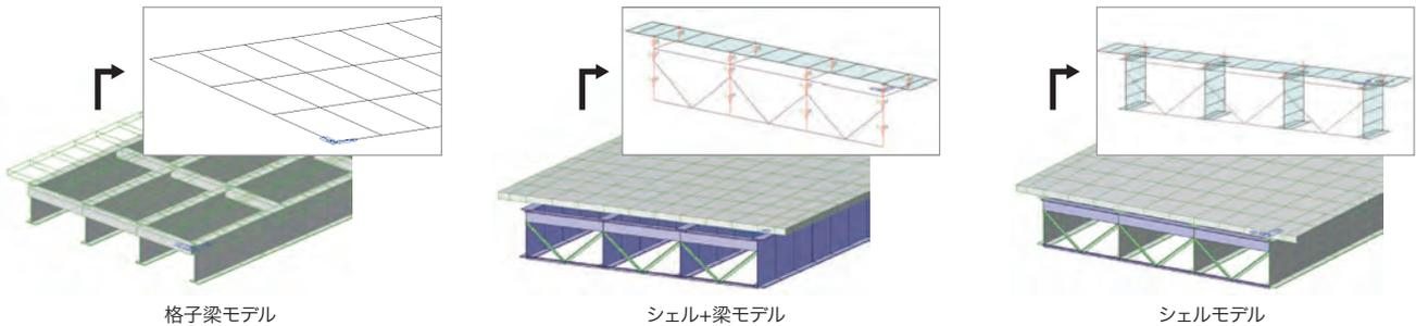
格子梁と板要素を組み合わせたモデリング - 板要素と梁要素から成る合成断面の合力(Fx, FY, Fzを、MX, Mz)をテーブルと断面力図で表示
