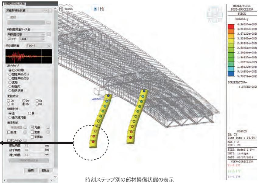
時刻ステップ別の部材損傷状態の表示
